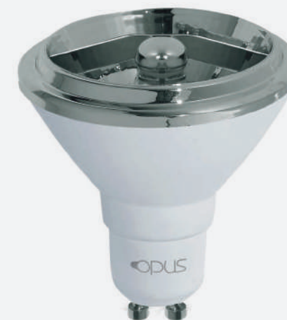
AR70 Dimerizável 4.8W | 300lm | Bivolt
