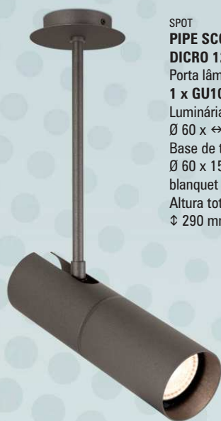
PENDENTE PIPE SCOPE DICRO 2011 Porta lâmpada: 1 x GU10 MR16 Luminária: Ø 60 x \leftrightarrow 210 mm Base de teto: Ø 75 x 100 mm Altura total - Haste fixa: \downarrow 960 mm Máx. \downarrow 580 mm Mín.
