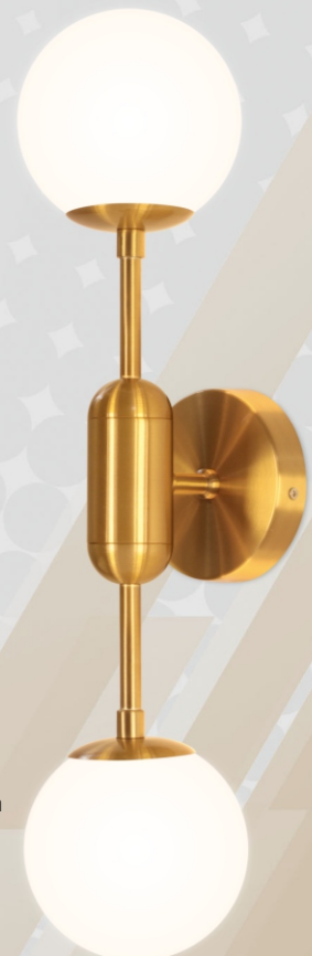
ARANDELA CAPSULE 1672 NECK Porta lâmpadas: 2 x G9 Halopin Tamanho da Cápsula: Ø 38 x \Phi 93 mm Difusores: Globos de vidro branco opalinos Ø 100 mm Luminária total: Ø 100 x \Phi 425 mm Base de parede: Ø 90 x \leftrightarrow 20 mm Profundidade: \leftrightarrow 125 mm
